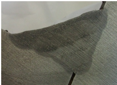
MSG-Schweißprobe, geschweißt mit neuem AMT Regelkonzept unter 5 bar Überdruck!
